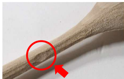
ウラ面加工時の切削不良 (刃物の食い込み)
